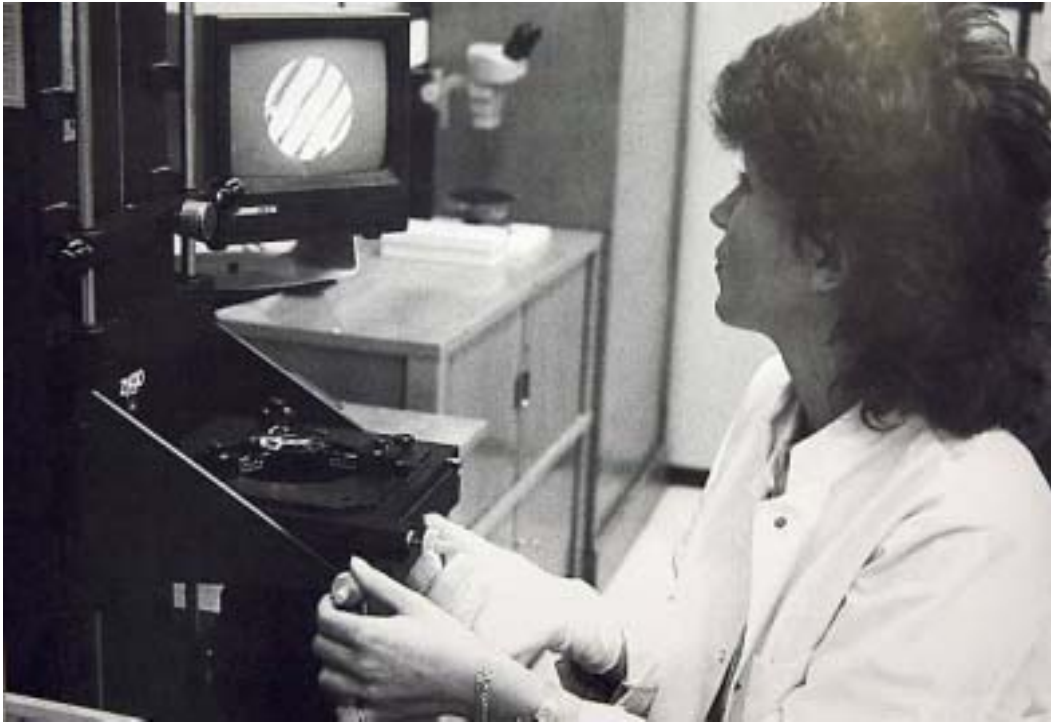
그림 42 간섭관측기를 이용한 표면 검사
